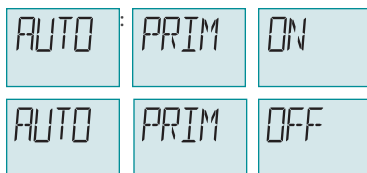
Figure 2-33 Réglages de l'auto-amorçage AUTO PRIM ON (AUTO-AMORÇAGE EN MARCHÉ) et AUTO PRIM OFF (AUTO-AMORÇAGE À L'ARRÊT)
